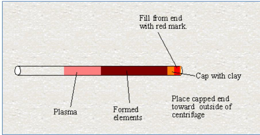
4. ثم توضع في جهاز الطرد المركزي الدقيق Micro centrifuge haematocrite لمدة خمس دقائق وبسرعة 10.000 إلى 15.000 دورة بالدقيقة. ويجب أن تكون النهاية المفتوحة للـ Capillary-tubes باتجاه محور الدوران ونهاية المغلقة بالمادة الخاتمة من الجهة الأخرى (الجهة الخارجية).
