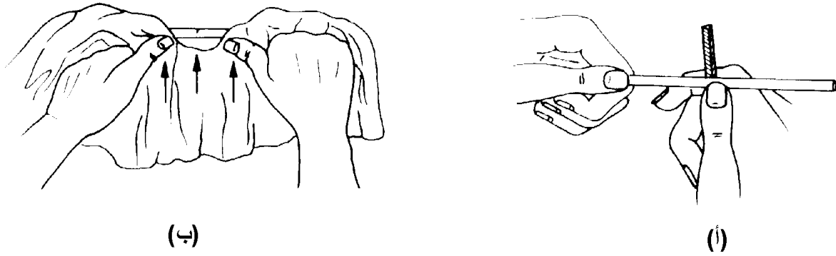
الشكل (٩): الطريقة الصحيحة لقطع أنابيب زجاجية
